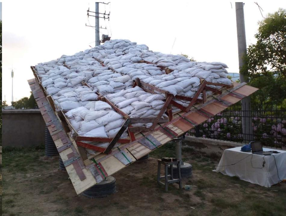
実際の架台載荷試験
