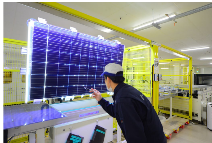
ラミネート加工後 外観検査
